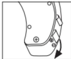
2. Retire la lámina de protección de la pila de botón (TIPO 13/PR48) incluida en los artículos suministrados e insértele en el compartimento de las pilas tras 10-15 minutos como se indica en el dibujo. Colóquela con la polaridad correcta (+/-).
