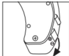
2. Entfernen Sie die Schutzfolie der im Lieferumfang enthaltenen Knopfzellen-Batterie (Typ 13/PR48) und legen Sie diese nach 10-15 Minuten wie abgebildet in das Batteriefach. Achten Sie beim Einlegen auf die korrekte Polarität (+/-) der Batterie.
