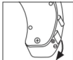
2. Retirez le film de protection de la pile bouton fournie (type 13/PR48) et insérez-la après 10-15 minutes dans le compartiment à piles, conformément à l'illustration. Assurez-vous de bien respecter la polarité (+/-) de la pile.
