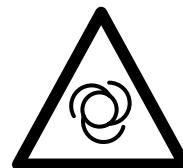
Figyelmeztetés! Az egység távirányított és fi gyelmeztetés nélkül megindulhat
