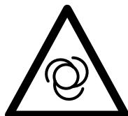
Pozor! Jednotka je vybavena automatickou regulací startu. Vezměme si zasaženou oblast - Zákaz vstupu!
