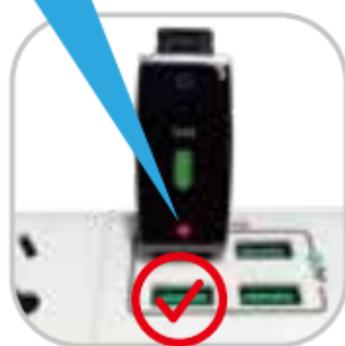
Bei niedrigem Batteriestand muss das Gerät an einem USB-Adapter aufgeladen werden. Sobald es voll aufgeladen ist, startet es automatisch und sollte vom Netz getrennt werden.
