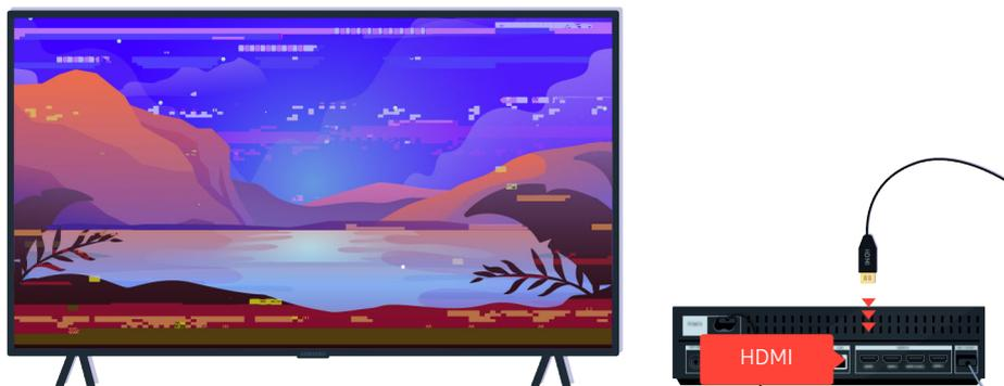
Wenn das externe Gerät 4K oder 8K UHD-Video unterstützt, müssen Sie ein spezielles HDMI-Kabel für die Wiedergabe von HDMI-Video verwenden.
