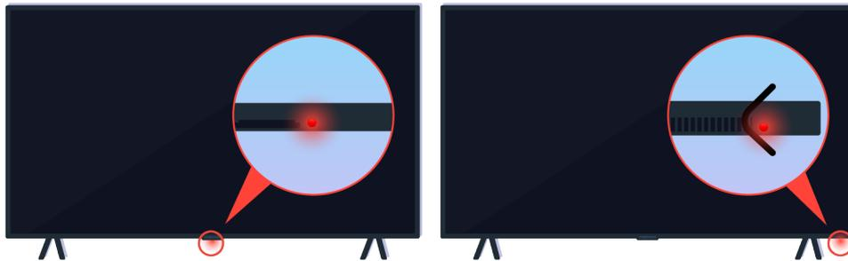
Vergewissern Sie sich, dass das Infrarotsignal der Fernbedienung gesendet und empfangen wird.
