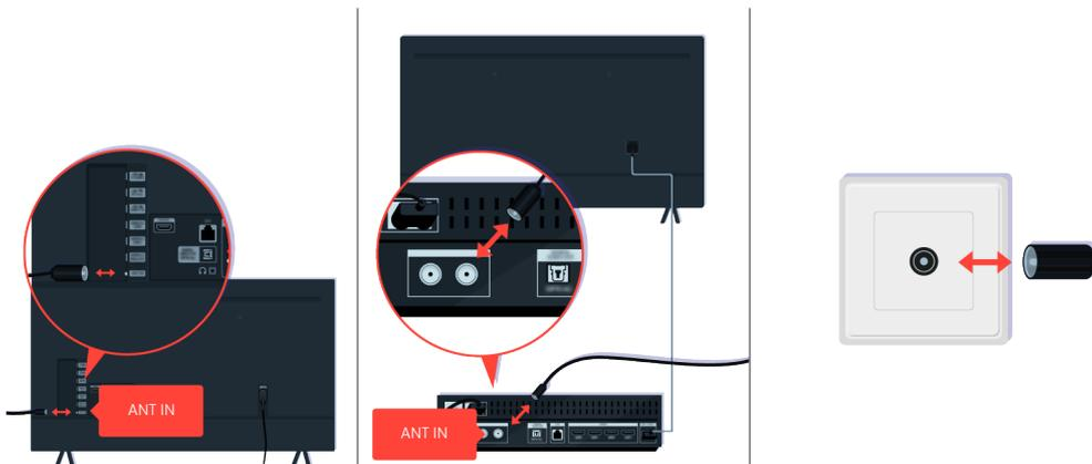
Überprüfen Sie die Anschlüsse der Antenne und des Eingangskabels.
