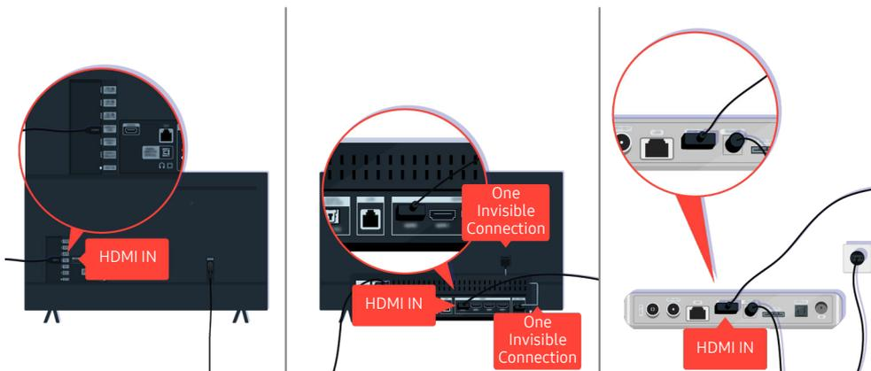
Überprüfen Sie den Anschluss des HDMI-Kabels an Ihren Fernseher oder die One Connect-Box.
