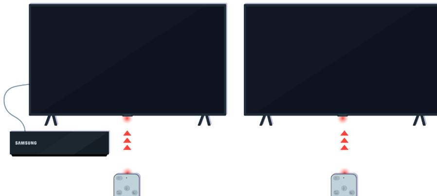
Die Fernbedienung funktioniert besser, wenn Sie sie direkt auf den IR-Empfänger richten.
