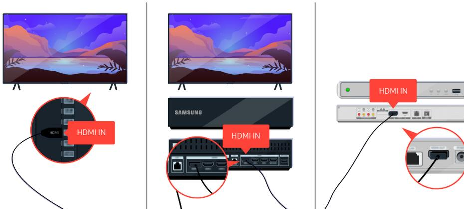
Wenn das Problem weiterhin besteht, versuchen Sie, ein anderes externes Gerät über ein HDMI-Kabel an den Fernseher anzuschließen. Wenn die Anzeige korrekt erfolgt, ist möglicherweise Ihr externes Gerät defekt.
