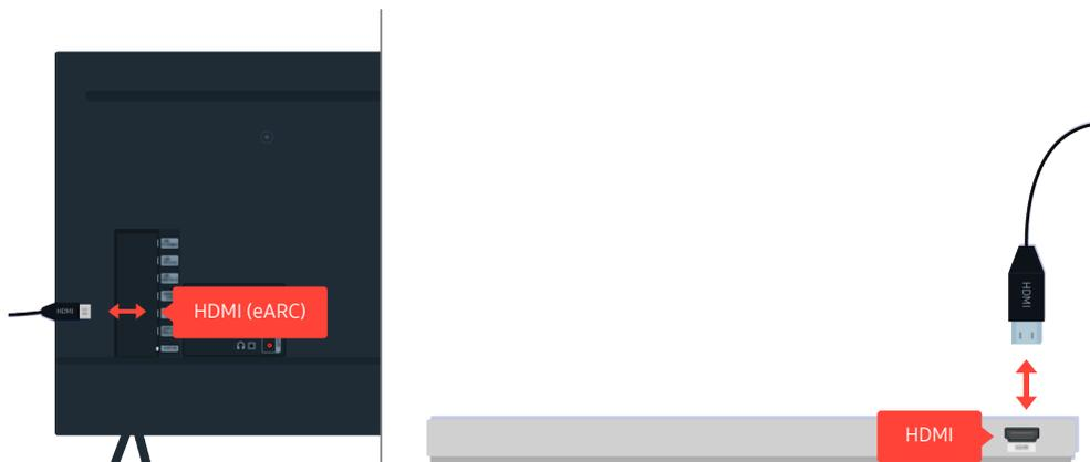
Wenn die Sound Bar keinen Ton ausgibt und mit einem HDMI-Kabel an den Fernseher angeschlossen ist, überprüfen Sie den HDMI (eARC)-Anschluss auf der Rückseite des Fernsehers.
