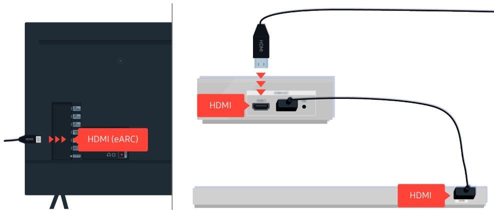
Überprüfen Sie den HDMI-Anschluss auf der Rückseite des Fernsehers, wenn Ihre Soundbar an einen Receiver angeschlossen ist und der Receiver über ein HDMI-Kabel an den Fernseher angeschlossen ist. Das Kabel muss an den HDMI (eARC)-Anschluss Ihres Fernsehers angeschlossen sein.
