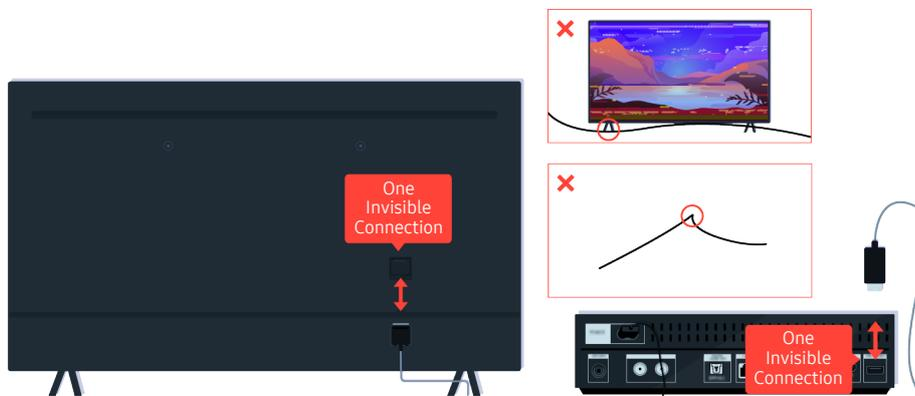
Wenn das Problem weiterhin besteht und Ihr Fernseher die One Invisible Connection verwendet, trennen und verbinden Sie die One Invisible Connection mit dem Fernseher und der One Connect-Box. Stellen Sie sicher, dass die One Invisible Connection weder gequetscht noch zu stark gebogen wird.
