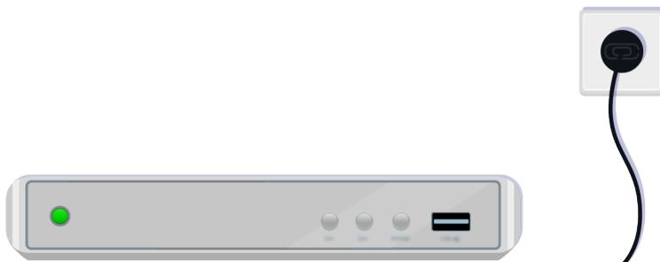
Wenn es nicht eingeschaltet wird, vergewissern Sie sich, dass das Netzkabel ordnungsgemäß mit dem Gerät und der Steckdose verbunden ist.
