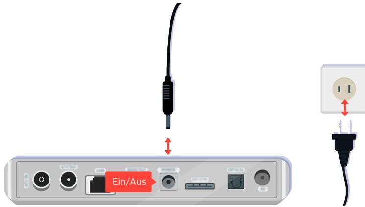
Wenn es nicht eingeschaltet wird, vergewissern Sie sich, dass das Netzkabel ordnungsgemäß mit dem Gerät und der Steckdose verbunden ist.
