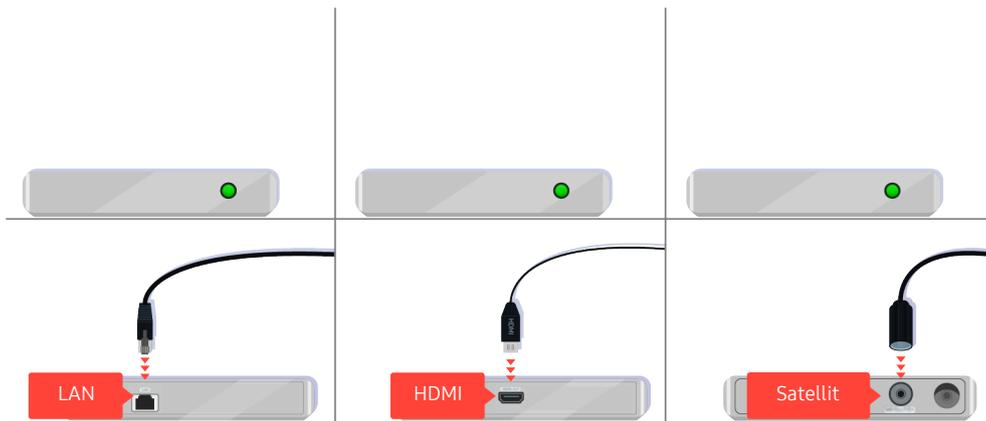
Überprüfen Sie die Kabelverbindung, wenn Sie einen Receiver verwenden, Welches Kabel Sie überprüfen müssen, hängt von der Art des Receivers ab.
