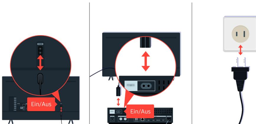
Trennen Sie zuerst vorübergehend kurz das Netzkabel und das HDMI-Kabel auf der Rückseite Ihres Fernsehers oder an der One Connect-Box, und unterbrechen Sie dann kurz die Verbindung des Netzkabels mit der Steckdose.
