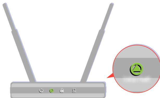
Vergewissern Sie sich, dass Ihr Zugangspunkt ordnungsgemäß funktioniert. um sicherzustellen, dass Ihr Zugangspunkt ordnungsgemäß funktioniert, überprüfen Sie die LED-Anzeigen.
