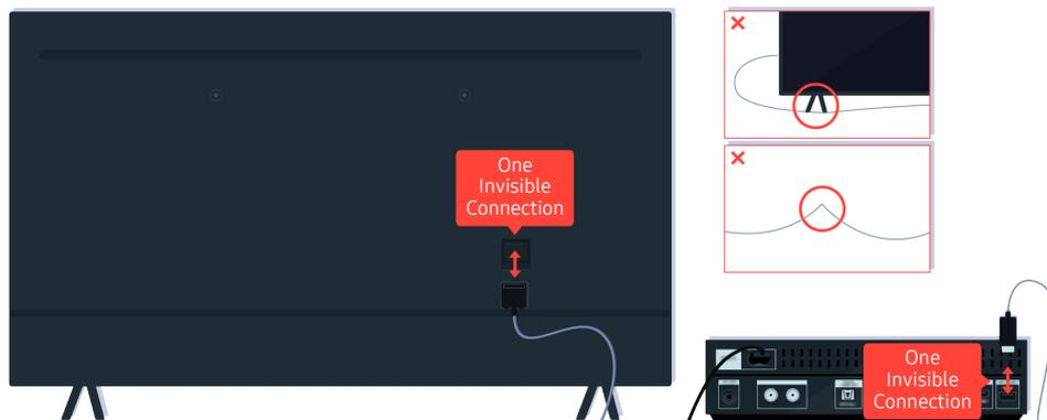
Trennen und verbinden Sie das Kabel der One Invisible Connection zwischen dem Fernseher und der One Connect-Box. Achten Sie darauf, dass das Kabel der One Invisible Connection nicht gequetscht oder zu stark gebogen wird.
