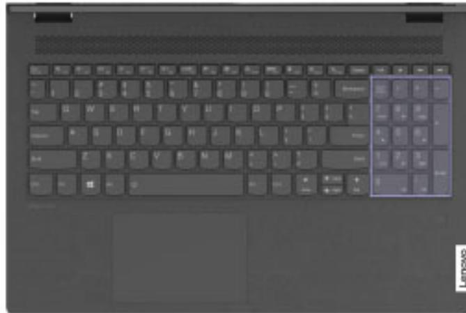
Einige Lenovo-Computer verfügen über einen speziellen numerischen Tastenblock ganz rechts auf der Tastatur. Dieser Tastenblock dient zur schnellen Eingabe von Zahlen und Rechenzeichen.
