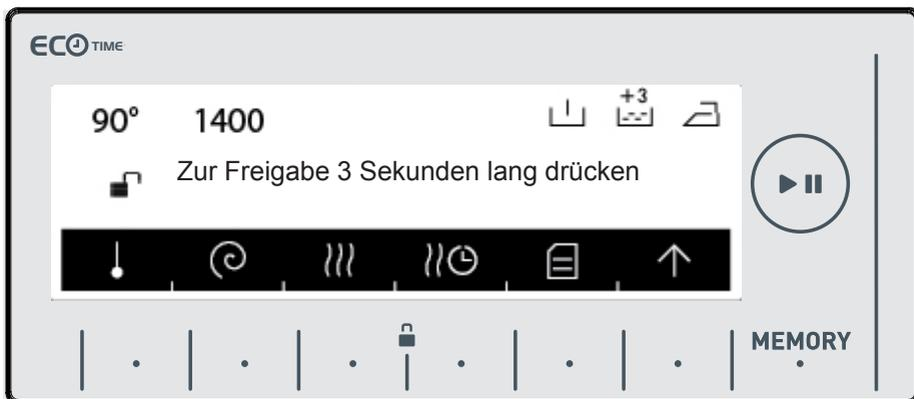
Wenn der Programmauswahlknopf bei aktiver Kindersicherung auf „Stopp“ eingestellt und anschließend ein anderes Programm ausgewählt wird, läuft das zuvor ausgeführte Programm weiter.
