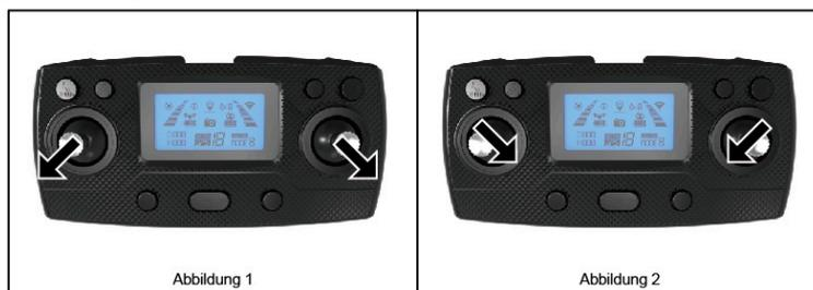
Zu diesem Zeitpunkt werden der Gashebel und der Steuerknüppel gleichzeitig in die linke untere Ecke und die rechte untere Ecke gedrückt (Abbildung 1) oder in die rechte untere Ecke und die linke untere Ecke (Abbildung 2) Gleichzeitig kann die Entriegelung abgeschlossen werden und der Motor kann nach dem Start fliegen.
