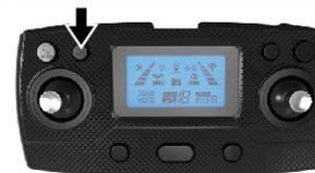
Wenn das GPS-Signal gut ist (die Anzahl der Satelliten ist größer als 7), können Sie die Drohne nach Hause starten, indem Sie die Einweg-Home-Taste auf der Fernbedienung drücken. Der Heimprozess ist derselbe wie der unkontrollierte Heimprozess. Steuern Sie die Drohne mit dem Steuerknüppel, um Hindernissen auszuweichen. Drücken Sie die Home-Taste erneut, um die Startseite zu verlassen, und der Benutzer kann die Kontrolle wiedererlangen.
