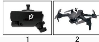
Die Fernbedienung ist eingeschaltet und die Kontrollleuchte blinkt. Halten Sie den Drohnenbatterieschalter gedrückt, die Batterieanzeige leuchtet von links nach rechts auf, die Drohnenanzeige blinkt, die Fernbedienungsanzeige wechselt von blinkend zu lang und der Code wurde erfolgreich abgeglichen.
