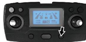
Drücken Sie die Taste für den Headless-Modus. Die Fernbedienung gibt ein "Eintauchen" aus. Wenn die Drohne entsperrt ist, befindet sich die Drohne während des Fluges in die Richtung, in die Sie den Flug lenken möchten. Wenn die Drohne entsperrt ist, zeigt die Richtung der Nase.
