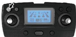
Stellen Sie die Drohne noch auf eine horizontale Fläche und halten Sie die Fernbedienung 5 Sekunden lang gedrückt, um einen Piepton zu erzeugen. Wie in der Abbildung gezeigt, wechselt das Drohnenlicht von schnellem Blinken zu langsamem Blinken.
