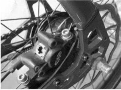
An der Nabe des Laufrades ist die Bremsscheibe befestigt, über die die Bremsleistung aufgebaut wird. Aufgrund der Dichte der Flüssigkeit sind die Kraftverluste bei diesem System erheblich geringer als bei einem Seilzugsystem.
