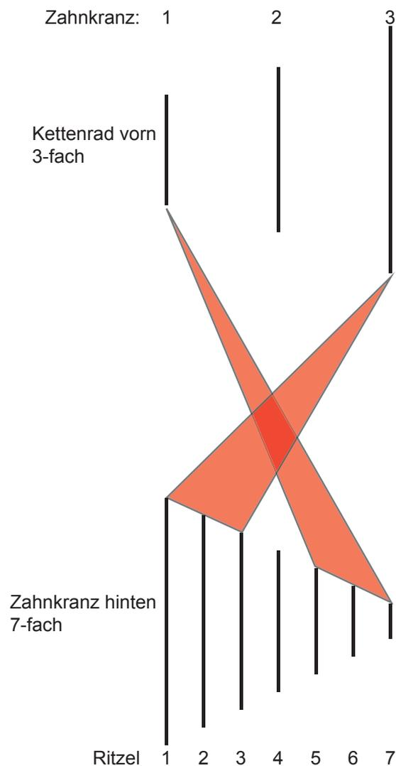
Da es sich bei der Kettenschaltung um ein hochkomplexes, außenliegendes Schaltsystem handelt, empfehlen wir dringend die wöchentliche Reinigung und Behandlung mit einem Kettenfließmittel. Eine Kettenschaltung kann sich insbesondere durch Dehnung der Schaltzüge sehr schnell verstellen. Das Nachjustieren ist jedoch recht einfach und kann mittels 2 Anschlagsschrauben und einer Rändelmutter erledigt werden.
