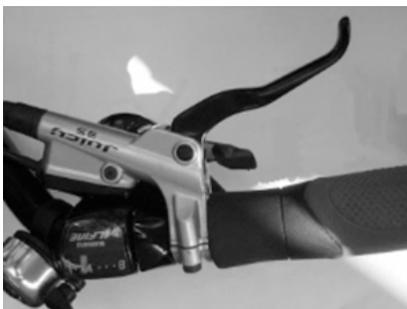
Am Bremshebel befindet sich ein Vorratsbehälter, aus dem per Druck auf den Hebel Bremsflüssigkeit in den Bremszylinder übertragen wird.
