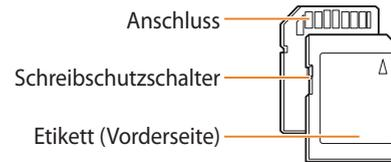
Sie können verhindern, dass Dateien gelöscht werden, indem Sie bei SD-, SDHC- oder SDXC-Karten den Schreibschutzschalter verwenden. Schieben Sie den Schalter nach unten, um die Sperre zu aktivieren, oder schieben Sie ihn nach oben, um die Sperre aufzuheben. Deaktivieren Sie die Kartensperre, wenn Sie Fotos oder Videos aufnehmen.
