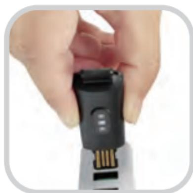
Wenn der Tracker einen niedrigen Batteriestand anzeigt, schließen Sie ihn an einen USB-Ladeadapter oder einen Anschluss mit 5 V-500 mA an.
