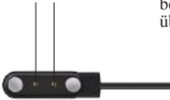
Stellen Sie sicher, dass der Ladestiftstecker genau mit den beiden Metallpunkten des Geräts übereinstimmt.
