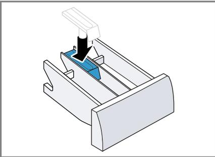
6. Die Öffnung für die Waschmittelschublade reinigen.
