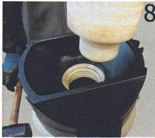
Den Einfülltrichter anschließend mit einem kurzen, kräftigen Schlag mit einem Gummihammer aufbringen. Um bei der Montage eine gleichmäßige Druckverteilung des Schlags zu gewährleisten, empfehlen wir eine geeignete Auflage zu benutzen. (Montagebolzen #977144.000 oder z.B. Holzbrett) o.ä.
