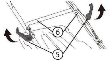
5. Stellen Sie sicher, dass die Bowdenzüge **oberhalb** der Haltebügel verlaufen.
