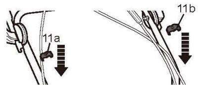
8. Durch Öffnen der Verriegelungshebel können Sie jetzt den oberen Haltebügel nach oben als auch nach unten in der Höhe nach Ihren Bedürfnissen verstellen und durch Schließen fixieren.
