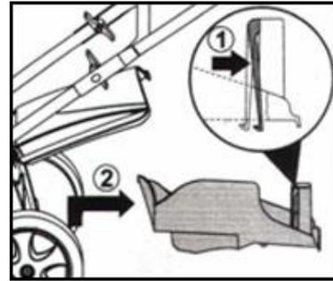
Dies funktioniert einfacher, wenn Sie den Einsatz mit dem hinteren Ende dabei leicht nach oben anheben.
