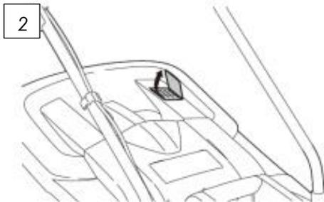
Zur Leerung heben Sie die am Grasfangsack aufliegende Heckklappe an und lösen Sie den Grasfangsack durch leichtes Anheben nach vorn aus der Verankerung.
