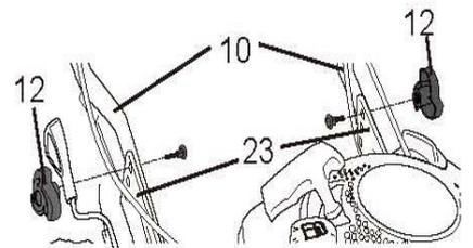
7. Befestigen Sie die beiliegenden Kabelclips und fixieren Sie somit die jeweiligen Kabel/Bowdenzüge an dem unteren Haltebügel.
