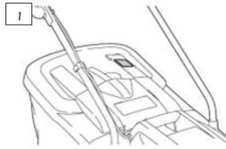
Ein geschlossener Füllstandswarner zeigt hierbei im Mähbetrieb an, dass der Grasfangsack voll ist (siehe Bild 1); ist die Klappe des Füllstandswarners im Mähbetrieb geöffnet, hat der Grasfangsack noch Platz um Gras aufzunehmen (siehe Bild 2).
