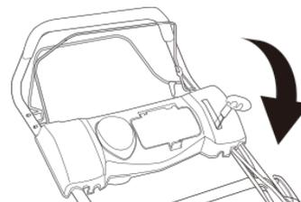
2. Drücken Sie bei kaltem Motor die manuelle Benzinpumpe („Primärpumpe“) 3-mal. Bei bereits warmem Motor drücken Sie die Pumpe nicht und gehen gleich zu Punkt 3 über.
