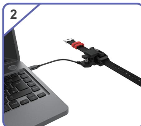
Schließen Sie den USB an einen Computer oder ein Ladegerät an (nicht im Lieferumfang enthalten).
