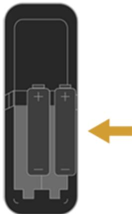
4. Schieben Sie den Batteriefachdeckel wieder an seinen Platz und überprüfen Sie durch Druck, dass er fest sitzt.
