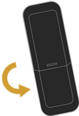
2. Drücken Sie fest auf die Vertiefung auf dem Batteriefachdeckel und schieben Sie ihn nach oben.
