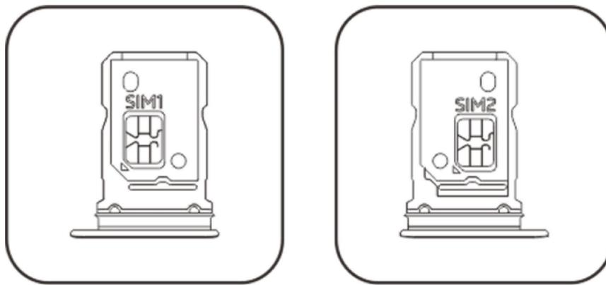
3. Halten Sie das Telefon mit dem Touchscreen nach oben gerichtet und führen Sie den Kartenhalter (mit der Nano- bzw.) in der durch die Pfeile angegebenen Richtung in das Telefon ein.
