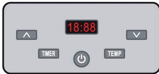
9. Si el contador del tiempo ha llegado a "0:00", el elemento calefactor se apaga en primer lugar. El ventilador continúa funcionando durante 10 minutos y el zumbador pita veinte veces.
