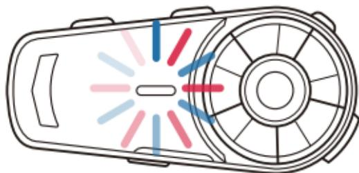
Halten Sie nach dem Einschalten des Geräts die Funktionstaste gedrückt, um in den Pairing-Modus zu wechseln. Die roten und blauen Anzeigen blinken schnell und die Sprachnachricht wird als Pairing angezeigt. Pairing-Modus für die Verbindung mit Bluetooth-Geräten wie Mobiltelefonen und Bluetooth-GPS.
