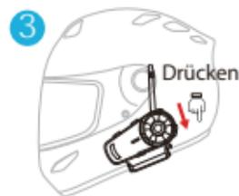
Einfügen des Hosts: Drücken Sie die Kit-Taste, der Host ist gesperrt und die Installation ist abgeschlossen.
