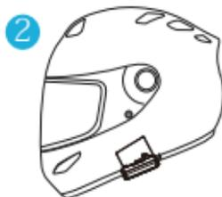
Halten Sie das Kopfhörer & Mikrofon-Kits in Position, stellen Sie die Lautsprecher und das Mikrofon ein und verstecken Sie das Lautsprecherkabel.
