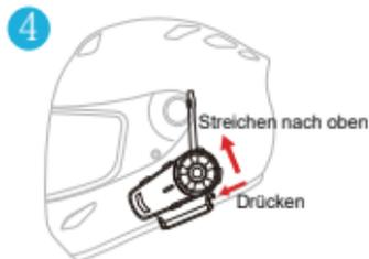
Entfernen Sie den Host: Drücken Sie den Knopf und schieben Sie ihn nach oben, um die Entfernung abzuschließen.
