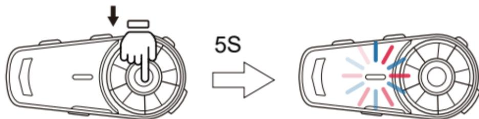
Wenn das Gerät eingeschaltet, halten Sie die Funktionstaste gedrückt, die roten und blauen Anzeigen blinken schnell und rufen den Pairing-Modus.
