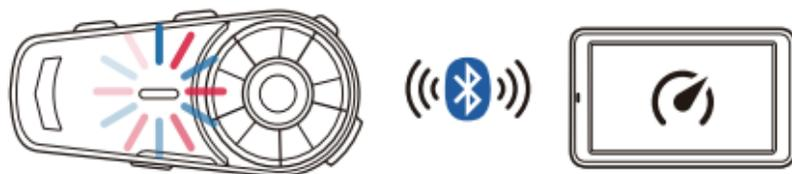
IKoppeln Sie abschließend den FX8 mit dem Geschwindigkeitsdetektor und schalten Sie nach dem Koppeln die GPS-Bluetooth-Funktion
