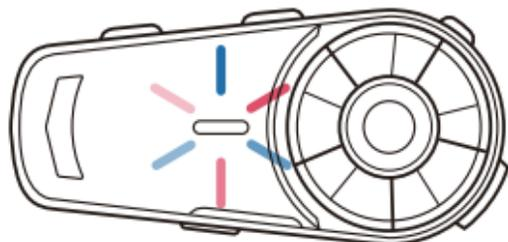
Halten Sie nach dem Einschalten des Geräts die Intercom-Taste gedrückt, um in den Suchmodus zu wechseln. Die roten und blauen Lichter blinken langsam. Der Suchmodus wird nur für die Intercom Verbindung zwischen FX8-Geräten verwendet.
