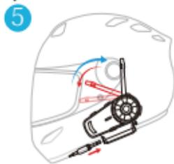
Stecken Sie das Mikrofonkabel ein. (Sie können die Antenne nach Bedarf öffnen oder verbergen.)
