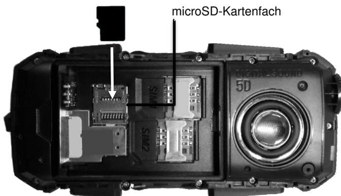
4. Klappen Sie den Riegel wieder nach unten und schieben Sie ihn in Pfeilrichtung **LOCK** zu.
