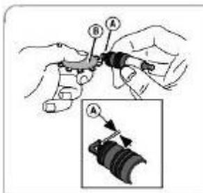
Prüfen Sie den Spalt (A) mit einer Kabeldicke (B). Setzen Sie ggf. den Spalt zurück. Bauen Sie die Zündkerze ein und ziehen Sie sie mit dem empfohlenen Drehmoment an. Die Einstellung des Spalts oder des Drehmoments finden Sie im Abschnitt **Spezifikationen**.
