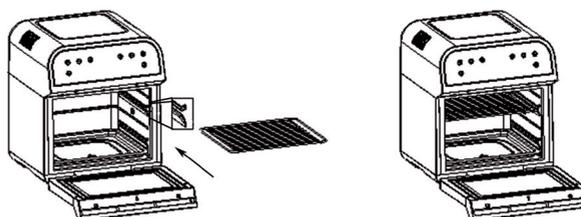
Ouvrez la porte avec précaution et faites glisser la grille sur les rails latéraux dans l'appareil, comme indiqué sur l'illustration.
