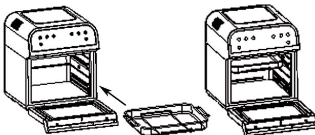
Ouvrez la porte avec précaution et faites glisser le panier à friture sur les rails latéraux dans l'appareil, comme indiqué sur l'illustration.
