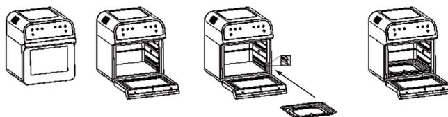
Öffnen Sie vorsichtig die Tür und schieben Sie das Tropfblech auf den Seitenschienen wie in der Abbildung gezeigt in das Gerät ein.
