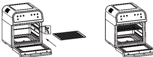
Öffnen Sie vorsichtig die Tür und schieben Sie das Grillgitter auf den Seitenschienen wie in der Abbildung gezeigt in das Gerät ein.
