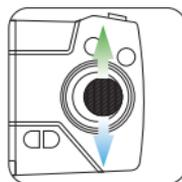
V/R Seitwärts Flugtrimmer: Drücken Sie kurz die Taste **STOP**, um die Funktion aufzurufen. Wenn die Drohne nach vorwärts driftet, drücken Sie den Richtungshebel nach unten, um die Drohne auszugleichen. Wenn die Drohne nach rückwärts driftet, drücken Sie den Richtungshebel nach oben, um die Drohne auszugleichen.
