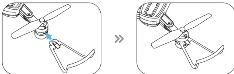
Installieren Sie den Propellerschutz wie in der Abbildung gezeigt an der Motorbasis. Stellen Sie sicher, dass der Propellerschutz an der Motorbasis befestigt ist, um unnötigen Verlust und Beschädigung während des Fluges zu vermeiden.
