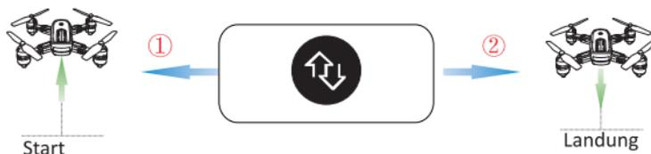
① Drücken Sie kurz die Taste „
