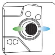
L/R seitwärts Flugtrimmer: Drücken Sie kurz die Taste **STOP**, um die Funktion aufzurufen. Wenn die Drohne nach links driftet, drücken Sie den Richtungshebel nach rechts, um die Drohne auszugleichen. Wenn die Drohne nach rechts driftet, drücken Sie den Richtungshebel nach links, um die Drohne auszugleichen.
