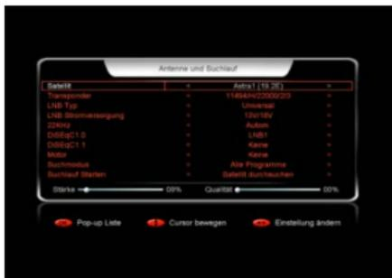
**10. Suchlauf starten:** Wählen Sie mit den ◀/▶ Tastenzwischen Satellit, Transponder, Multi-Satellit, Multi-Transponder oder Blindsearch. Bei der Multi Suche können Sie mit OK die Liste zum Auswählen der Transponder bzw. Satelliten öffnen.
