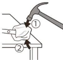
Hinweis: Möglicherweise müssen Sie mehrmals auf das Ende klopfen, bis die Schnappverbindungen im Inneren brechen.
