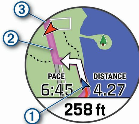
Auf der Karten werden die aktuelle Position (1), der zu verfolgende Track (2) sowie das Ziel (3) angezeigt.
