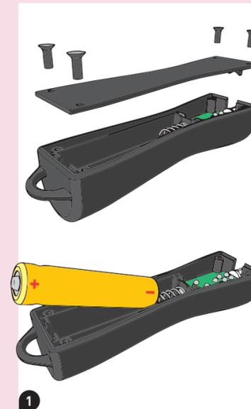
1. Öffnen Sie das Batteriefach mit einem kleinen Kreuzschlitz-Schraubendreher und setzen eine neue 1,5-Volt-Batterie vom Typ LR03 (AAA, Micro) ein. Bitte achten Sie auf die richtige Polung! Verschließen Sie das Batteriefach nach dem Einsetzen der Batterie direkt wieder.
