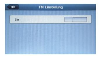
Wenn Sie den oberen Schalter nun aktivieren, startet der FM Transmitter. Mit der unteren Leiste lässt sich die Frequenz einstellen. Beide Frequenzen, sowohl im Navigationsgerät als auch im Radio, müssen übereinstimmen. Am besten sucht man sich hierbei im voraus eine freie Frequenz im Radio und stellt diese dann im FM Transmitter ein. Wenn FM Transmitter eingeschaltet ist, erfolgt die Soundausgabe ausschließlich über das Radio. Das Gerät selbst schaltet sich dann stumm.
