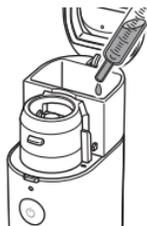
5. Positionieren Sie die Verneblermembranabdeckung.
