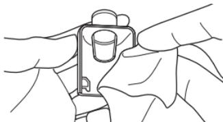
Wenn sich das Medikament zu stark an der Membran ansammelt, endet die Vernebelung möglicherweise. Schalten Sie das Gerät in diesem Fall aus und entfernen Sie den Maskenadapter. Absorbieren Sie das Medikament mithilfe eines fusselfreien Tuchs.
