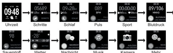
Durch Berühren des Touchbutton (1) für ca. 3 Sekunden aktivieren Sie das Untermenü (falls vorhanden). Durch langes Drücken des Touchbutton (1) für ca. 3 Sekunden im Untermenü bestätigen Sie eine Auswahl oder gelangen zurück zum Hauptmenü.
