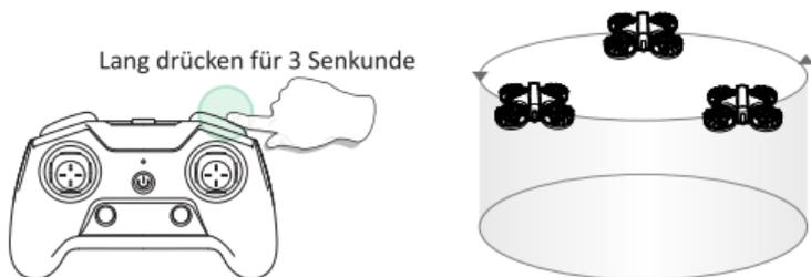
Drücken Sie die Kreis Flug Taste ca.3 Sekunden lang. Die Drohne wechselt dann in den Kreis Flug-Modus. Sie können den Vorgang beenden, indem Sie dieselbe Taste nochmals lang drücken.
