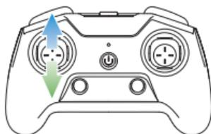
④ Ziehen Sie den Gashebel schnell nach oben und dann nach unten. Wenn die Verbindung geklappt hat, werden die Anzeiger der Drohne sich von einem Blinken, zu einem stetigen Leuchten ändern.
