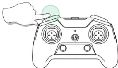
Diese Drohne kommt mit 3 Geschwindigkeitsmodi (niedrig/mittel/hoch). Drücken Sie die Speed Switch-Taste oben links am Sender, um die Geschwindigkeit zu wechseln. "Di" zeigt niedrige Geschwindigkeit an, "DiDi" zeigt mittlere Geschwindigkeit an und "DiDiDi" zeigt hohe Geschwindigkeit an.
