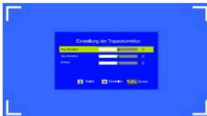
Schritt 2: Wenn das projizierte Bild als (1) angezeigt wird, drücken Sie die
