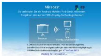
2.Wählen Sie das Menü [ Settings ] auf Ihrem Android-Gerät-wählen Sie die Funktion [ Screen mirroring ]-wählen Sie Ihren Miracast-Empfänger mit dem Namen [ V7-AnCast-XXXX]-Ihr Android-Gerät Bildschirm wird auf der Projektionswand nach 3 Sekunden angezeigt.
