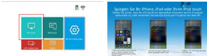
3. Wählen Sie das Menü [ die Einstellungen ] auf Ihrem iOS-Gerät – Öffnen Sie die Funktion [ Wi-Fi ] – Verbinden Sie das iOS-Gerät mit demselben Heimnetzwerk wie der Beamer.
