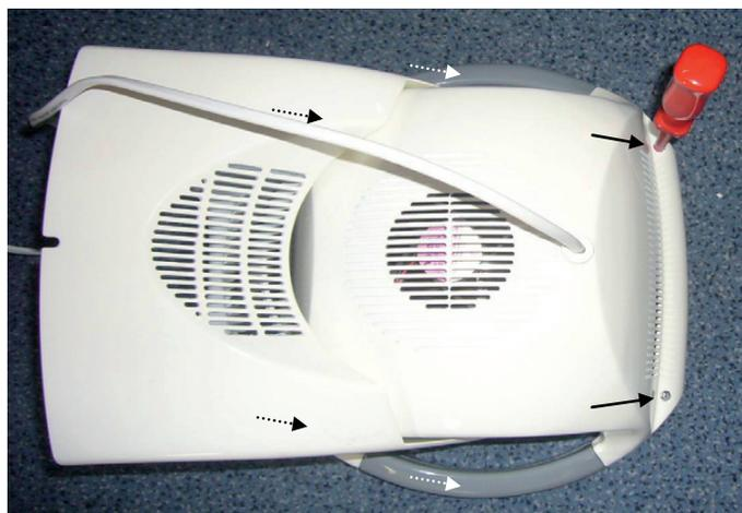
3. Das Gehäuse aufstellen, dabei das vordere Teil mit der Keramik-Glasscheibe auf der Unterlage liegen lassen.
