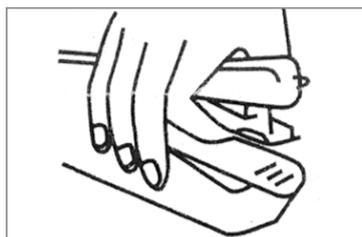
3. Heben Sie die Stoffklemme (12) an, legen Sie den zu bearbeitenden Stoff zwischen Stoffklemme und Stichplatte (11) und senken Sie die Stoffklemme. **BEACHTEN SIE:** Der Stoff wird beim Nähen nach links transportiert. Deshalb muss er am linken Ende in die Nähmaschine gelegt werden.
