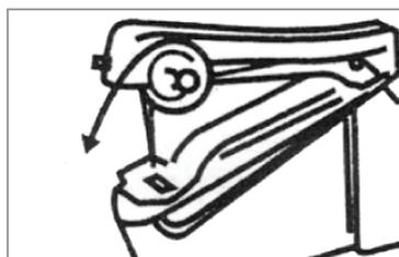
3. Drehen Sie das Handrad (7), bis der Arm (2) und die Nadel (14) oben sind.
