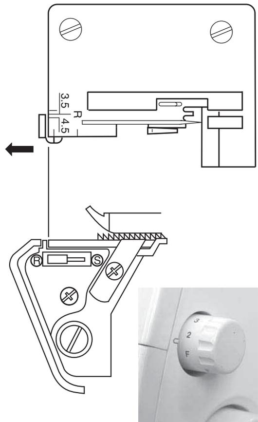
Hinweis: Um einen schönen Rollsaum zu erzeugen, verwenden Sie Bauschgarn als Obergreifefaden und normalen Faden für die Nadel und den Untergreifer.
