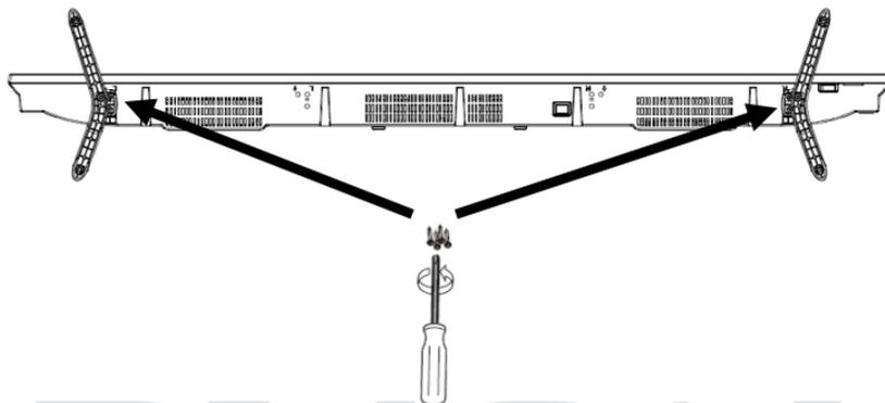
Verwenden Sie die beiliegenden Schrauben, um die Standfüße an den entsprechenden Vorrichtungen auf der Geräteunterseite wie abgebildet anzubringen.
