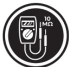
**UTILISEZ TOUJOURS UN MULTIMÈTRE NUMÉRIQUE D'UNE IMPÉDANCE D'AU MOINS 10 MEGAOHM lorsque vous effectuez des tests électriques sur des véhicules pour éviter d'endommager l'électronique embarquée.**
