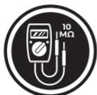
**UTILIZZARE SEMPRE UN MULTIMETRO DIGITALE CON ALMENO 10 MEGAΩHM DI IMPEDENZA quando si eseguono test elettrici sui veicoli per evitare di causare danni ai componenti elettronici di bordo.**
