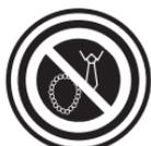
**NO USES ROPA SUELTA O JOYAS CUANDO TRABAJAS EN UN MOTOR. La ropa suelta puede quedar fácilmente atrapada en el ventilador del motor, las poleas, las correas, etc. y las joyas son altamente conductoras, lo que provoca quemaduras graves o descargas eléctricas si entra en contacto con la electricidad.**
