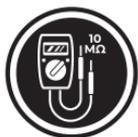
**ВСЕГДА ИСПОЛЬЗУЙТЕ ЦИФРОВОЙ МУЛЬТИМЕТР С СОПРОТИВЛЕНИЕМ НЕ МЕНЕЕ 10 Мом при проведении электрического теста на транспортных средствах во избежание повреждения бортовых электронных компонентов.**
