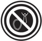
**TRAGEN SIE BEI ARBEITEN AN EINEM MOTOR KEINE WEITE KLEIDUNG ODER SCHMUCK. Lockere Kleidung kann sich leicht in Lüfter, Riemenscheiben, Riemen usw. des Motors verfangen, und Schmuck ist sehr leitfähig, was bei Kontakt mit Elektrizität schwere Verbrennungen oder Stromschläge verursacht.**
