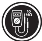
**UTILIZA SIEMPRE UN MULTÍMETRO DIGITAL CON AL MENOS 10 MEGOHMS DE IMPEDANCIA cuando realice pruebas eléctricas en vehículos para evitar causar daños a los componentes electrónicos a bordo.**
