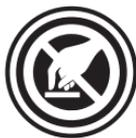
Для предотвращения **Для предотвращения сильных ожогов НЕ ПРИКАСАЙТЕСЬ К ГОРЯЧИМ ЧАСТЯМ ДВИГАТЕЛЯ.** Детали двигателя сильно нагреваются при работающем двигателе.
