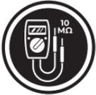
**BENUTZEN SIE IMMER EIN DIGITALES MULTIMETER MIT MINDESTENS 10 MGOHM IMPEDANZ, wenn Sie elektrische Tests an Fahrzeugen durchführen, um Schäden an elektronischen Komponenten an Bord zu vermeiden.**
