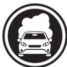
**SOLAMENTE REALIZA LA PRUEBA EN UN ÁREA BIEN VENTILADA** ya que el vehículo produce monóxido de carbono, un gas tóxico y venenoso, y partículas cuando el motor está en marcha.
