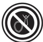
**NE PORTEZ PAS DE VÊTEMENTS AMPLES OU DE BIJOUX LORSQUE VOUS TRAVAILLEZ SUR UN MOTEUR. Les vêtements amples peuvent facilement se prendre dans le ventilateur du moteur, les poulies, les courroies, etc. Les bijoux sont très conducteurs et peuvent causer de graves brûlures ou des chocs électriques s'ils entrent en contact avec l'électricité.**
