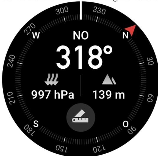
Tippen Sie auf die Schaltfläche auf dem Bildschirm, um die aktuelle 12-Uhr-Position zu sperren. Wenn Sie dann die Richtung ändern, wird auf dem Bildschirm der Winkel zwischen der neuen 12-Uhr-Richtung und der vorherigen 12-Uhr-Richtung angezeigt.
