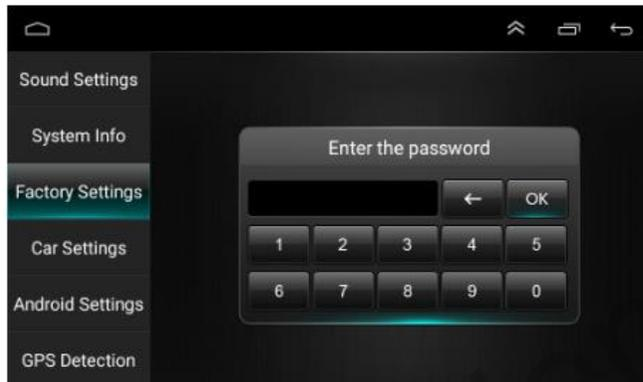
Benutzer können hier die Gerätevoreinstellungen ändern. Wir empfehlen Benutzern nicht, die Parameter hier zu ändern, da sonst das Gerät irreparabel beschädigt wird (Passwort: 8888).
