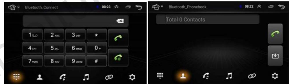
Tippen Sie auf das Bluetooth-Symbol, um auf diese Seite zuzugreifen. Öffnen Sie die Bluetooth-Option auf dem Mobiltelefon und suchen Sie nach dem Gerät mit dem Namen "BT Car". Der PIN-Code lautet "0000". Benutzer können auch auf Einstellungen zugreifen, um die Bezeichnung und die PIN des Bluetooth-Geräts zu ändern
