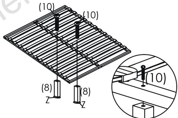
11. Verbinden Sie die Stützfüße [8] mit dem Gestell mittels 2 Schrauben [10].
