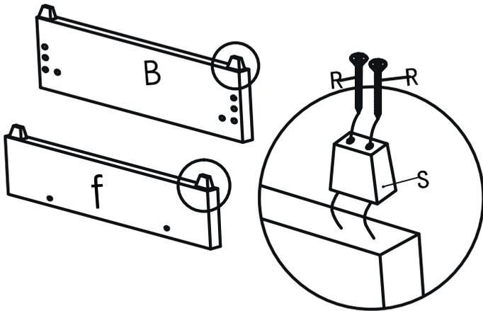
1. Verbinden Sie die 2 Stützfüße [S] mit dem Fußteil [B] mittels 4 Schrauben [R].
