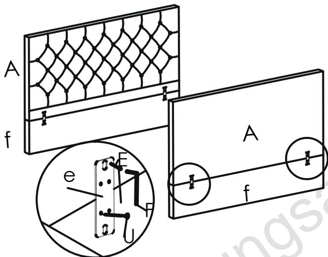
3. Verbinden Sie das Kopfteil oben [A] mit dem Kopfteil unten [f] mittels der 4 Lochplatten [e] und der Schrauben [U] und [E].
