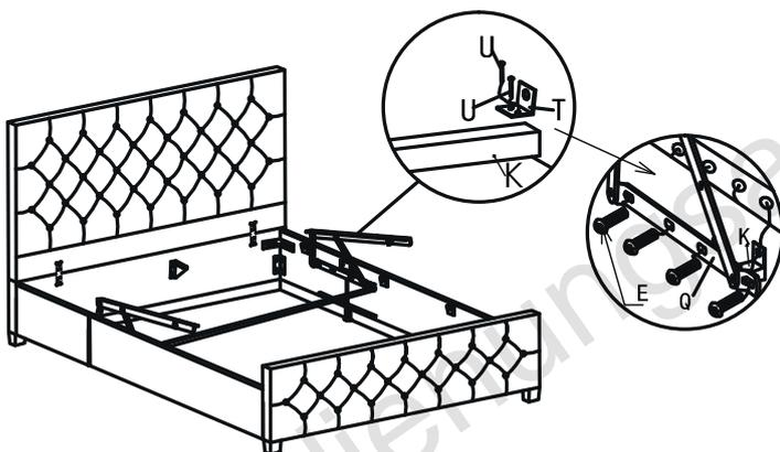
17. Verbinden Sie das Querstrebe [K] mit dem Bettgestell mittels 2 Metallwinkel [T] und 4 Schrauben [U].
