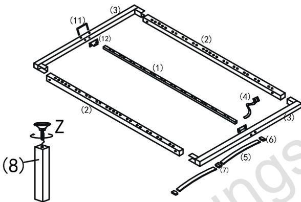
2. Drehen Sie jeweils einen Drehfuß [Z] in das Befestigungsloch der 2 Stützfüße [8].
