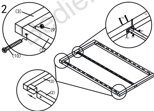
3. Verbinden Sie das Rahmenteil [2] mit dem Rahmenteil [3] mittels einer Schraube [10] und einer Sechskantmutter [9].
