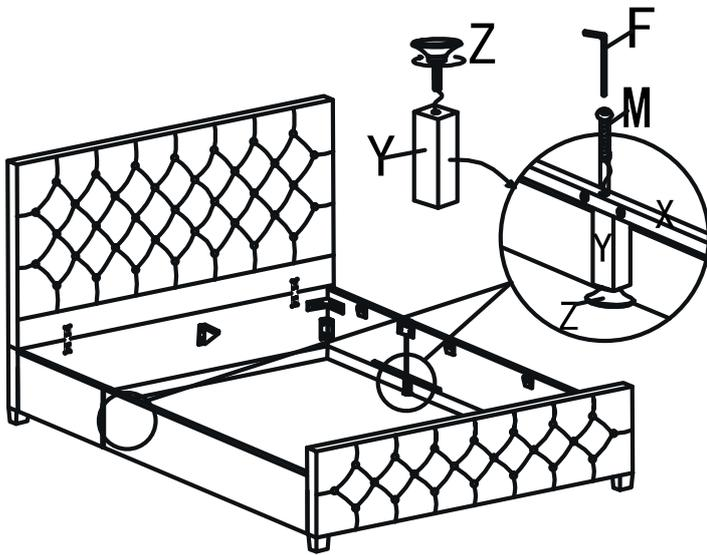
14. Drehen Sie jeweils einen Drehfuß [Z] in das Befestigungsloch der 2 Stützfüße [Y].
