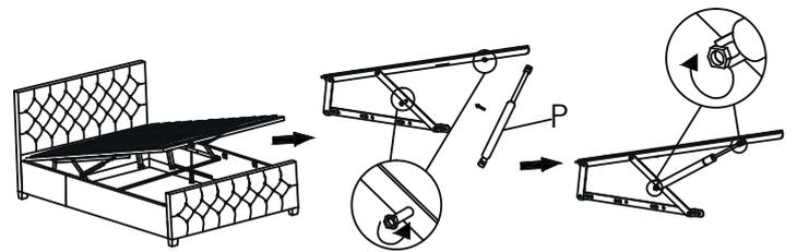
22. Klappen Sie das Lattenrost nach oben. Eine zweite Person muss das Lattenrost in der oberen Position halten.
