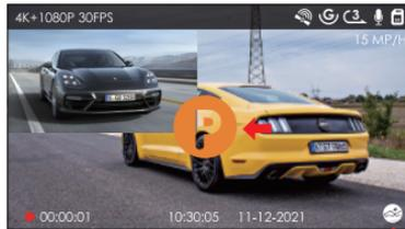
Wenn die Dashcam keine Bewegung oder Vibration innerhalb von 5 Minuten erkennt, wird der Kollisionserkennungsmodus automatisch ausgelöst, das P-Symbol wird in der Mitte des Dashcam-Bildschirms angezeigt und dann wird die Dashcam sich ausschalten. Nachdem Dashcam ausgeschaltet wurde, wenn es erkennt, dass sich das Auto bewegt oder vibriert, schaltet es sich automatisch ein und zeichnet 1 Minute lang auf und schaltet sich dann aus.
