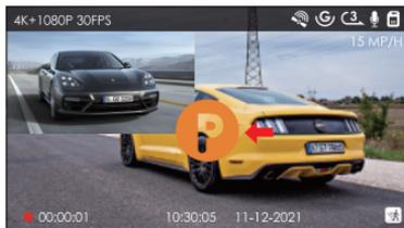
Wenn die Dashcam keine Bewegung innerhalb von 5 Minuten erkennt, wird der Bewegungserkennungsmodus automatisch ausgelöst und das P-Symbol wird in der Mitte des Bildschirms angezeigt (was anzeigt, dass der Bewegungserkennungsmodus aktiviert wurde). Die Frontkamera erkennt die Bewegung des Objekts und startet die Bewegungserkennungsaufzeichnung. Die Dauer jeder Bewegungserkennungsaufzeichnung beträgt 30 Sekunden.
