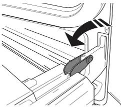
**2.** Die Tür so weit wie möglich schließen. Die Tür mit beiden Hände festhalten – diese nicht am Griff festhalten. Die Tür einfach entfernen, indem sie weiter geschlossen und gleichzeitig nach oben (a) gezogen wird, bis sie sich aus ihrem Sitz löst (b).
