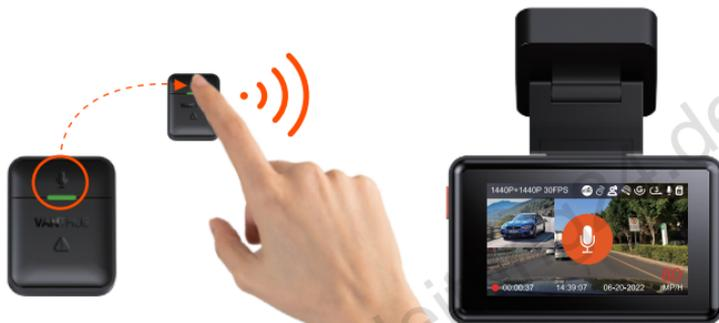
2. Nachdem die Verbindung erfolgreich hergestellt wurde, drücken Sie kurz die Notfall-Taste
