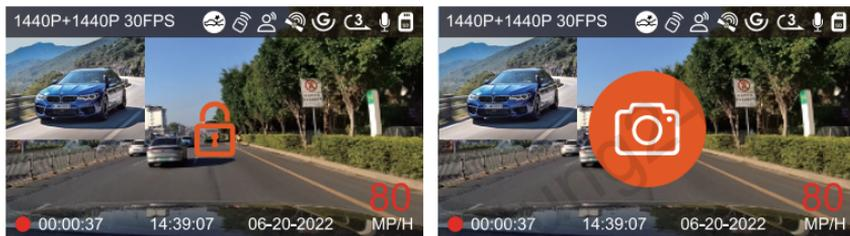
**Das automatische Sperrereignisvideo** wird ausgelöst, wenn das Auto getroffen/gerüttelt wird, die Dashcam erkennt die Vibration und sperrt automatisch das aktuelle Video, das im Ereignisvideordner gespeichert ist.
