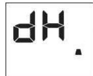
Ideal zur Reduzierung der Raumluftfeuchtigkeit (Frühling und Herbst, Feuchträume, Regenperioden, usw.). Im Entfeuchtungsmodus ist das Gerät wie im Kühlmodus vorzubereiten, wobei der Abluftschlauch angebracht ist, damit die Feuchtigkeit nach außen abgeleitet werden kann. So stellen Sie diesen Modus richtig ein:
