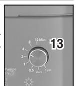
14. Ist alles montiert, dann stellen sie nun den Wahlschalter in die Stellung „Test“. Die Pumpe fängt nun bei genügend geladenem Akku an zu arbeiten. Sie saugt das Wasser selbstständig an. Achten sie dabei, dass der Filter des Ansaugschlauches dabei unter Wasser ist. Drehen Sie nun den Regler an der Steuerung auf die gewünschte Pumpzeit.
