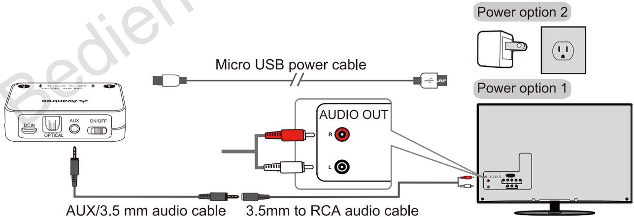
Nachdem Sie HT4186 eingeschaltet und die Kabel angeschlossen haben, sollten Sie den Ton über Ihre Kopfhörer hören können; Wenn nicht, stellen Sie sicher, dass Sie die rot/weißen TV-Anschlüsse mit der Aufschrift „AUDIO AUSGANG“, andere Rot/Weiß-Ports sind falsch. Stellen Sie sicher, dass Ihr TV-Lautsprecher auf „Externer Lautsprecher“ eingestellt ist.
