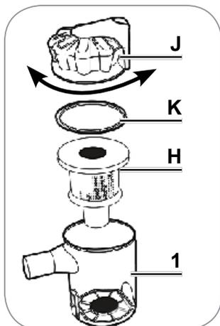
2. Den Deckel des Staubbehälters (J) ein Stück gegen den Uhrzeigersinn drehen und nach oben abnehmen.
