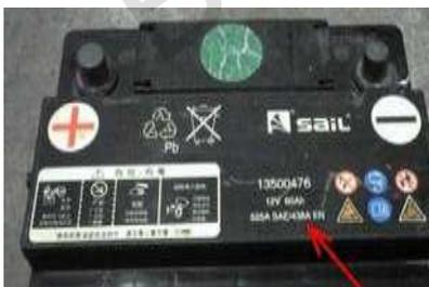
CCA: Kaltstartstrom, spezifiziert von SAE&BCI, am häufigsten verwendeter Wert zum Starten der Batterie bei 0 °F (-18 °C).
