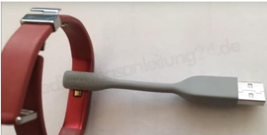
2. Drückt mit einer gebogenen Büroklammer oder SIM-Karten Werkzeug drei Sekunden lang in den kleinen Knopf an der Seite des Ladekabels.
