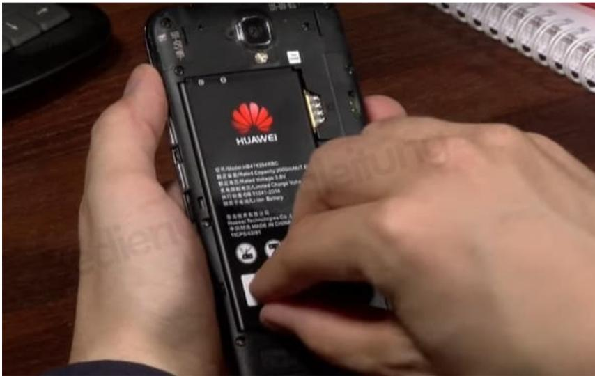
4. Achtet beim Einsetzen der Micro-SIM darauf, dass die goldenen Kontakte nach unten und abgeschrägte Ecke nach rechts oben zeigt.
